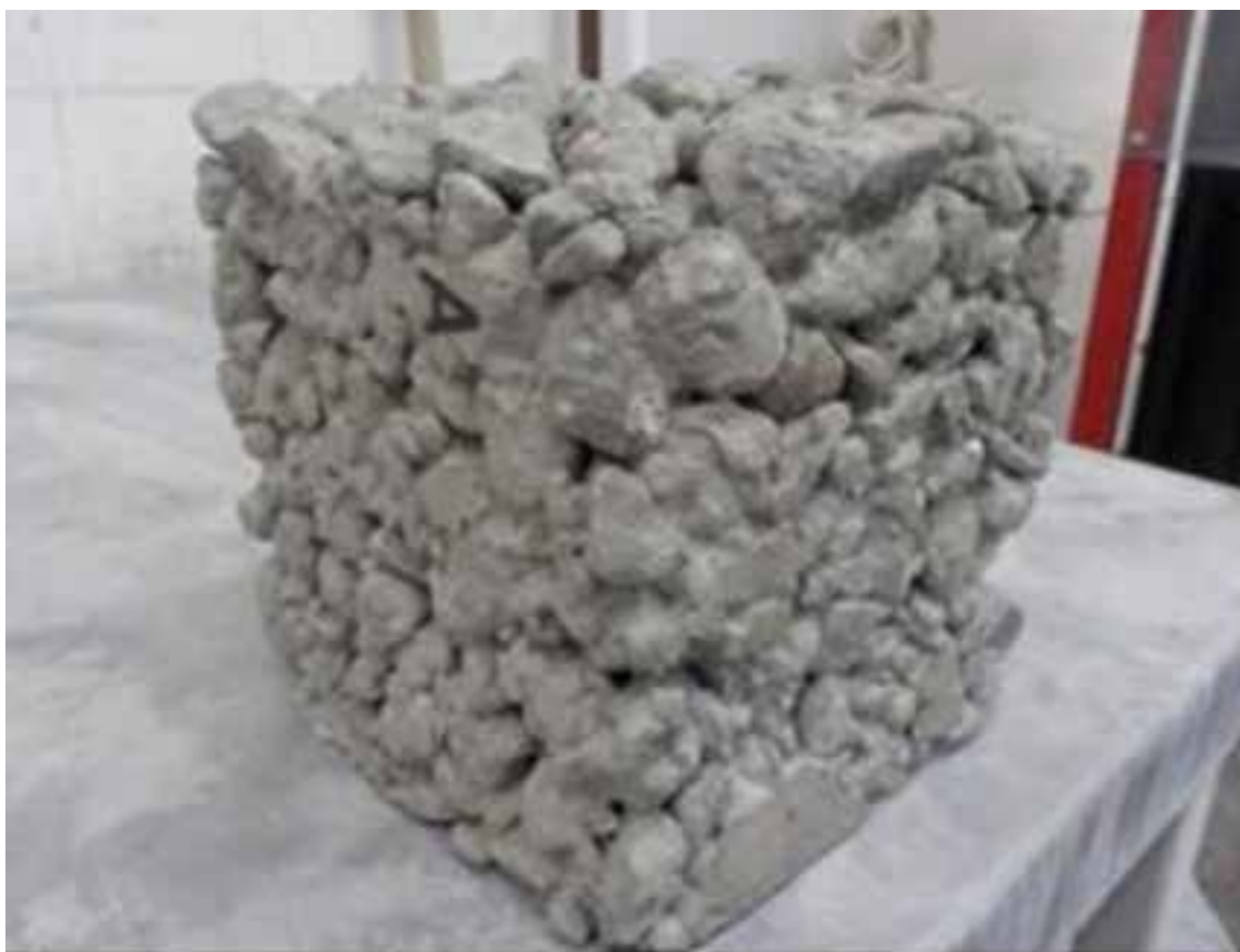
Obr.: 16 Kontrolní zkušební těleso MCB
