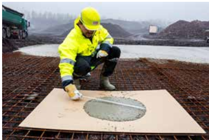
Obr.: 26 a Obr.: 27 Stanovení konzistence sednutí-rozlítím směsi QCC
