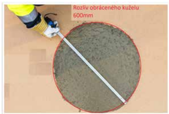
Obr.: 26 a Obr.: 27 Stanovení konzistence sednutí-rozlítím směsi QCC
