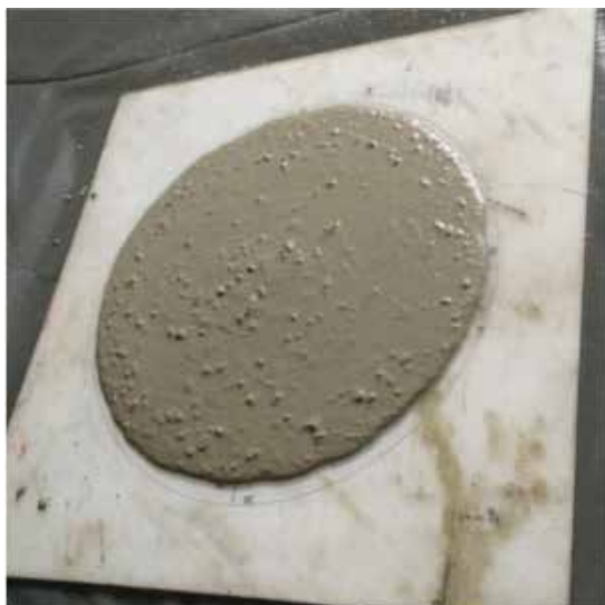
Obr.: 3 Rozlití Haegermannova kužele
