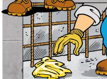
Odstraň všechny nečistoty a smetí z bednění.
