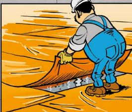
Zakryj beton rohožemi nebo pásy fólie, ujistí se, že mají dostatečné přesahy, zajisti je proti nadzvednutí větrem.
