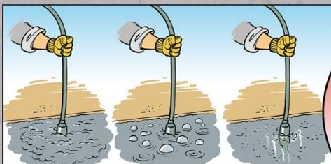
Nech beton úplně usadit. Vibrátor rychle ponoř.
